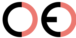
Faux marquage CE (trop éloignée)
